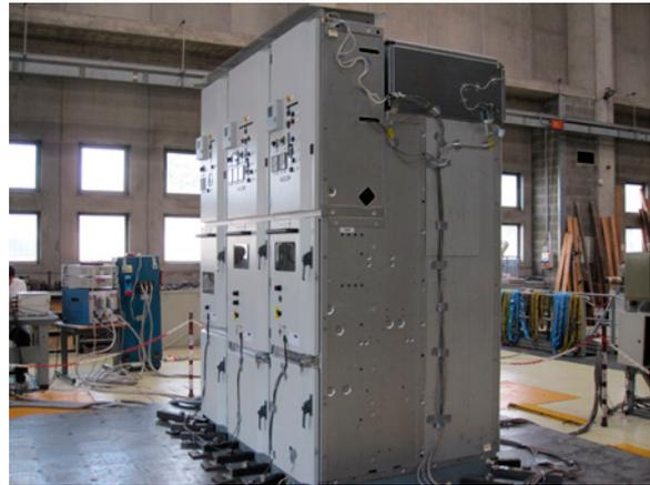
Experimenteller Erdbebestest eines Schaltschranks
