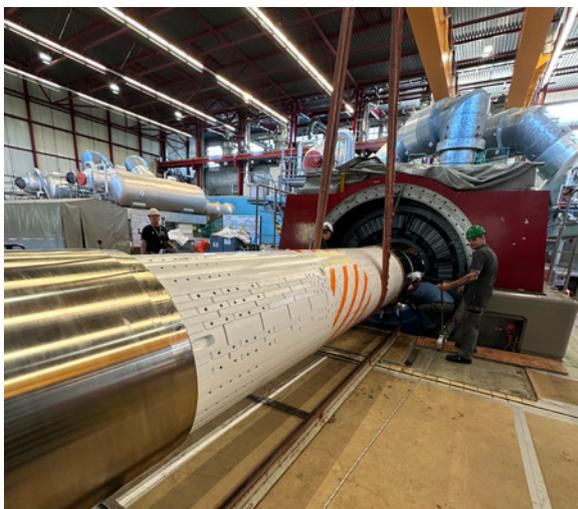
Wartung und Revision im Bereich der Starkstromtechnik mit dem Ziehen des 15,5 kV Generatorrotors.
