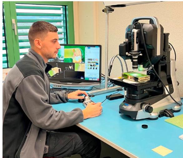
Einsatz des digitalen Mikroskops für Materialuntersuchungen, Fehleranalysen von elektrischen Komponenten bis zum Detektieren von gefälschten Bauteilen.
