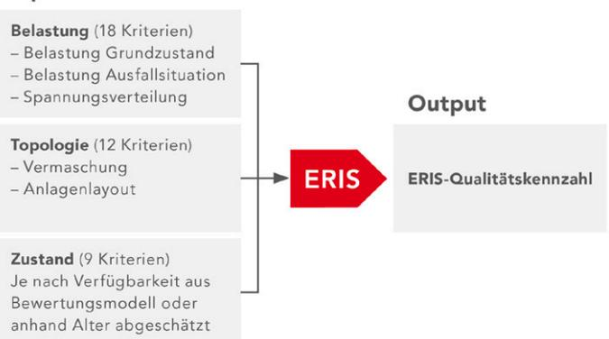
Abbildung 3: schematische Darstellung von ERIS
