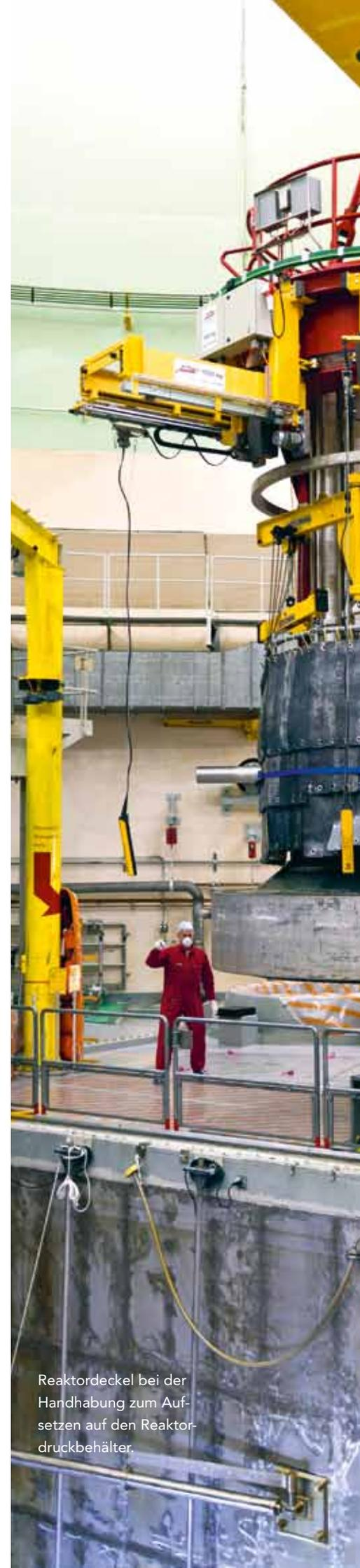
Reaktordeckel bei der Handhabung zum Aufsetzen auf den Reaktordruckbehälter.
