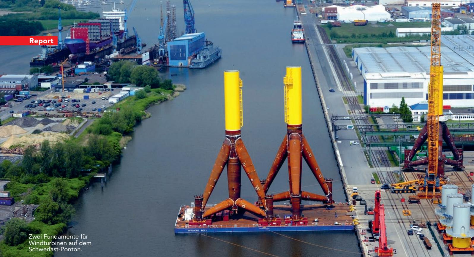
Zwei Fundamente für Windturbinen auf dem Schwerlast-Ponton.
