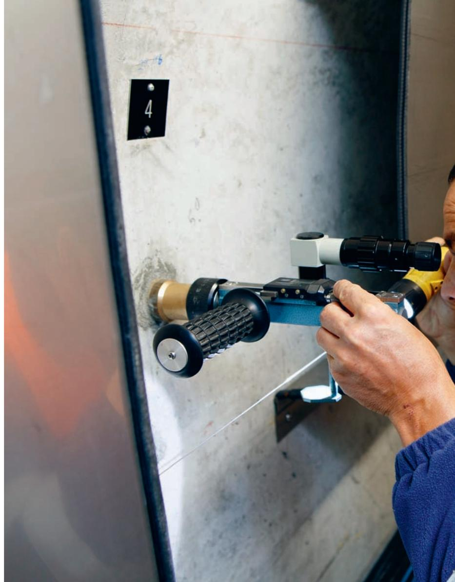
Arnold Flepp prüft mikromillimetergenau die Position des horizontal gespannten Stahldrahts, um die See-Tal-Bewegung zu messen. Alles im Normalbereich, bestätigt er.
