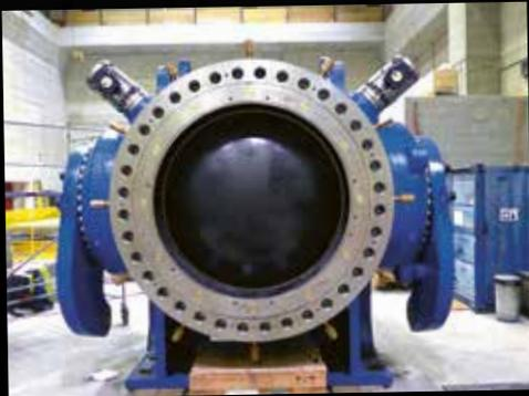
... **Kugelschieber:** Er ist «der Wasserhahn des Kraftwerks», regelt den Wasserfluss zwischen Druckleitung und Turbine.
