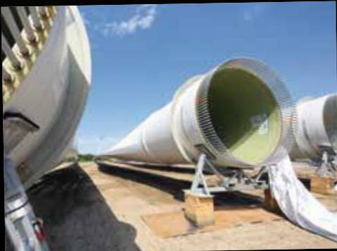
**Rotorblätter:** Sie sorgen für den Antrieb. Die riesigen Rotorblätter sind 57 Meter lang und wiegen je 13,6 Tonnen.
