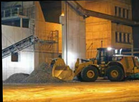
**Befüllung:** Die Verbrennung in Block 3 läuft vollautomatisch. Die Öfen der Blöcke 1 und 2 werden manuell per Pneulader befüllt.
