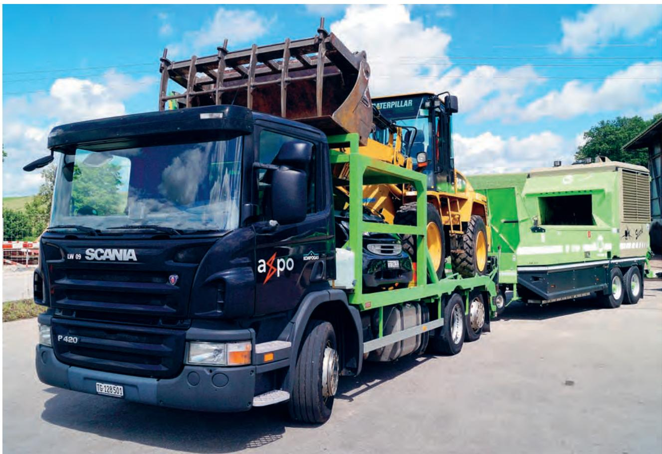
Ein Shredderzug der mobilen Dienste für die Aufbereitung vor Ort: Lastwagen mit Pneu-lader und Smart sowie dem Shredder als Anhänger.
